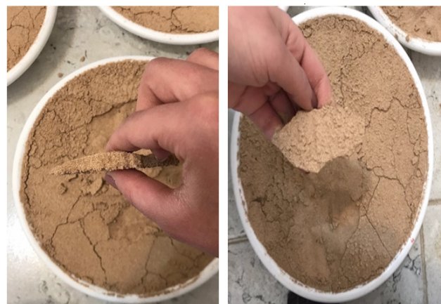
شکل ۶: سله‌ی تشکیل شده بر اثر پاشیدن مالچ زانتان با مقدار مؤثر ۲ گرم بر مترمربع
