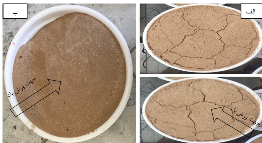
شکل ۵: الف) تصویر بالایی مربوط به نمونه قبل از فرسایش و شکل پایینی مربوط به نمونه بعد از فرسایش؛ ب) فرسایش نمونه‌ی شاهد
