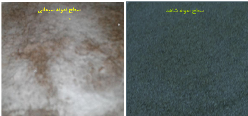
شکل ۴: تصویری از سطح نمونه شاهد و نمونه سیمانی شده با فناوری MICP [۴۵]
