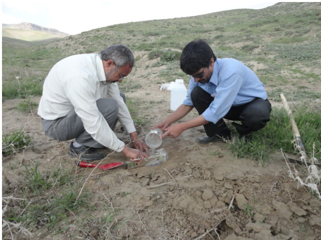
شکل ۹: اندازه‌گیری وزن مخصوص در محل با روش ماسه بادی [۱]
