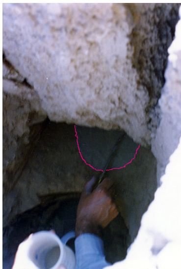
شکل ۱۰: حفر نقب و چاله برای اندازه‌گیری وزن مخصوص ظاهری با ماسه بادی در لایه‌های زیرین پروفیل، محدوده چاله با خط قرمز مشخص شده است. [۴]
