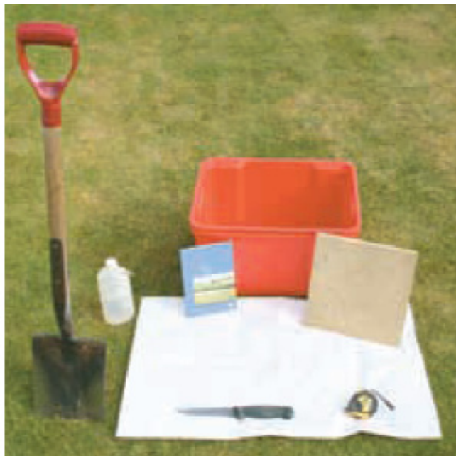
شکل ۱ نمایی از جعبه ابزار مورد نیاز برای اجرای روش ارزیابی بصری کیفیت خاک (VSA)
