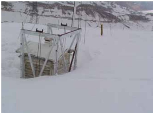
شکل ۵- انباشته شدن برف در اثر توری نصب شده
