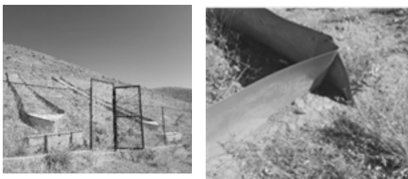
شکل ۵: نمای کلی در میدان شمالی، شکل راست) جدا شدن محیط کرت توسط ورقه فلزی (منبع: نویسندگان و اداره کل منابع طبیعی استان همدان ۱۳۹۹-۱۴۰۱)
