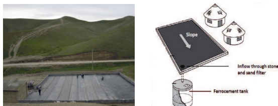
شکل ۳. سطوح عایق آبیگیر
