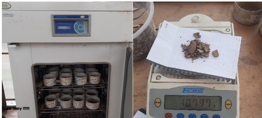
شکل ۴: خشک کردن رسوب در کوره آزمایشگاهی و توزین نمونه‌های خشک‌شده
