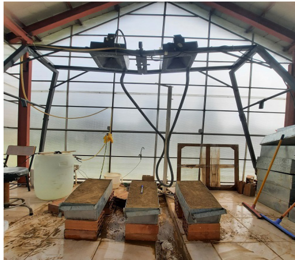
شکل ۳: قرارگیری کرت‌های آزمایشگاهی در زیرسامانه شبیه‌ساز باران
