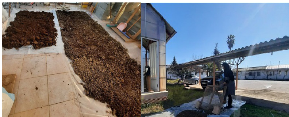
شکل ۲: مراحل هوا خشک شدن و الک کردن خاک برداشت شده از جنگل
