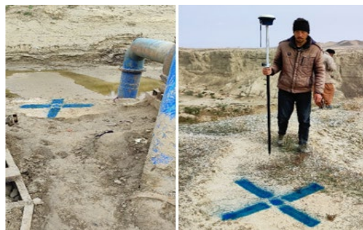
شکل ۴: ایجاد تارگت در سطح منطقه مورد نقشه‌برداری با استفاده از DGPS
