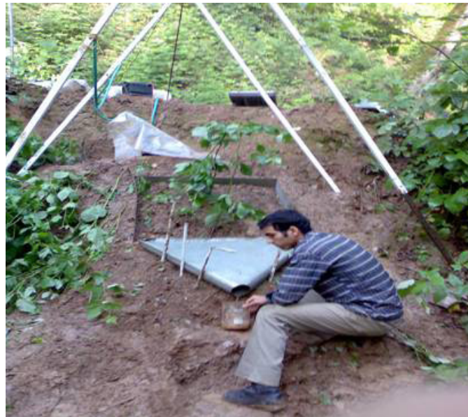
شکل ۱- جمع‌آوری رواناب حاصل از شبیه‌ساز باران بر روی ترانشه خاکبرداری جاده جنگلی
