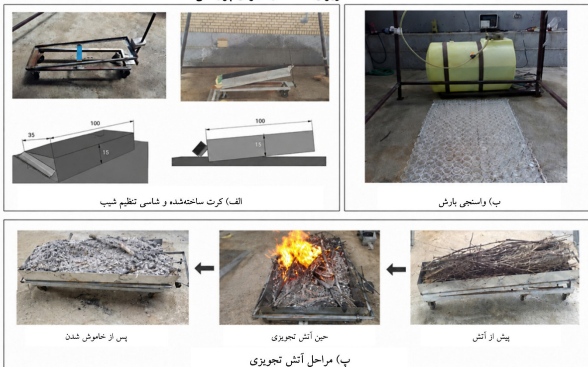
شکل ۳- مستندات تصویری سامانه و اجرای پژوهش: الف) کرت ساخته‌شده و شاسی تنظیم شیب؛ ب) واسنجی بارش؛ و پ) مراحل پیش از آتش، حین آتش تجویزی و پس از خاموش شدن. تصاویر از مستندات همین پژوهش استخراج و فقط از نظر چیدمان و وضوح بهینه‌شده‌اند.
